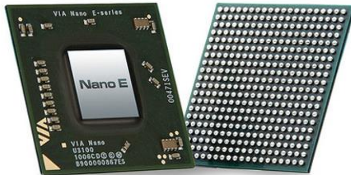
Рисунок А1 - 64 разрядный процессор суперскалярной микроархитектуры
